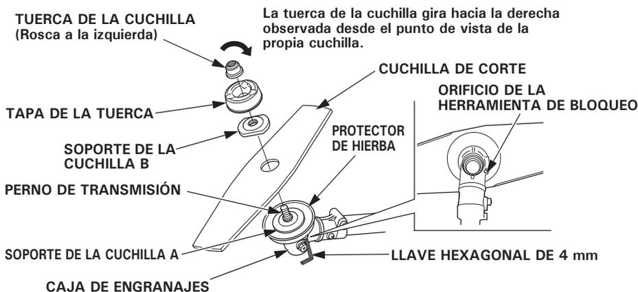
3. Vuelva a montarlo todo en el orden inverso al de extracción (consulte la página 5). Asegúrese de montar la cuchilla con el borde de corte en la dirección de rotación. Apriete la tuerca de la cuchilla aplicando un par de: 16,7 – 19,6 N·m (1,7 – 2,0 kgf·m)
