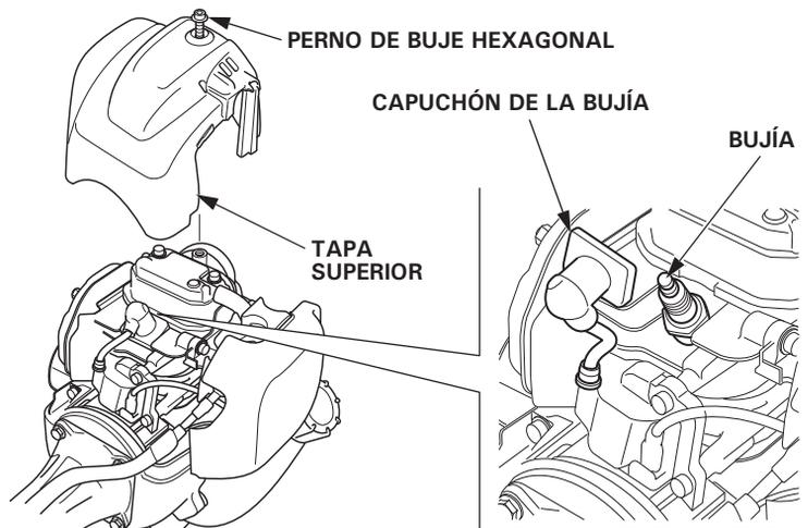
3. Inspeccione visualmente la bujía. Deséchela si tiene desgaste aparente o si el aislador está agrietado o astillado. Limpie la bujía con un cepillo de alambre si debe volver a utilizarla.
