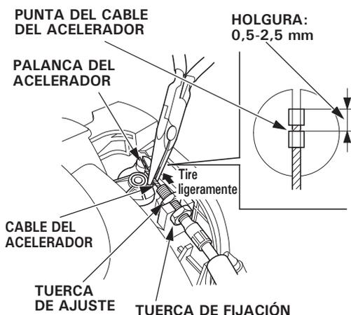
5. Apriete correctamente la tuerca de fijación del cable del acelerador.
