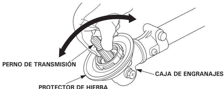
Después de la “Limpieza de la caja de engranajes”, la “Inspección del desgaste del protector de hierba” y la “Inspección del perno de transmisión”, asegúrese de montar el soporte de la cuchilla A en la caja de engranajes antes de colocar la cuchilla de corte. Para colocar la cuchilla de corte, consulte la página 56.
