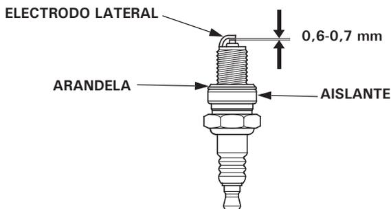
5. Compruebe que la arandela de la bujía esté en buen estado y enrosque la bujía con la mano para evitar forzar la rosca.
