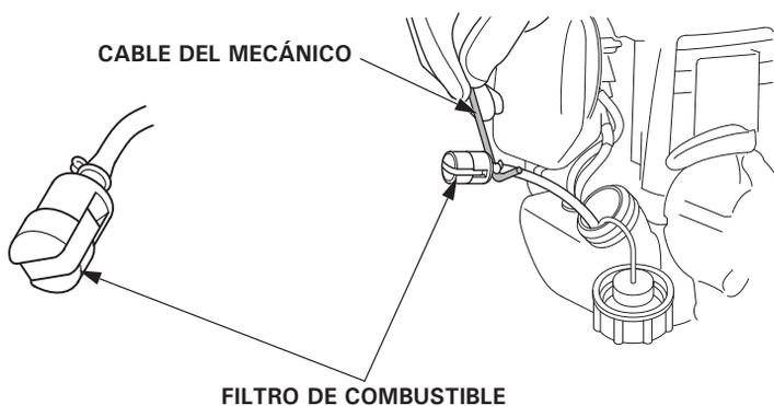
4. Compruebe la suciedad del filtro de combustible. Si el filtro de combustible está sucio, lávelo suavemente con disolvente no inflamable o con un alto punto de inflamabilidad. Si el filtro de combustible está muy sucio, sustitúyalo.
