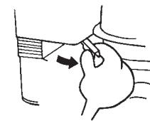
1. Mueva la palanca del acelerador completamente hacia la derecha.
